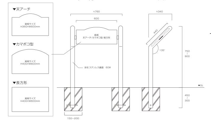
①柱とベースプレートをセットし垂直に設置します。(仮組み立て・固定)
