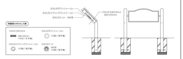
※柱を埋め込む前に銘板をセットしますと、水平・垂直が出しにくくなります。
