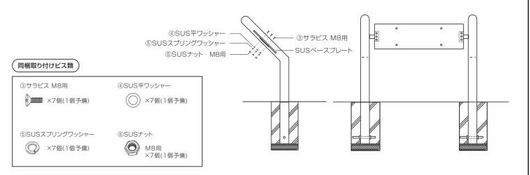
※基礎を固定する前にボルト、ナットを締めつけると、柱の垂直が出しにくくなります。
