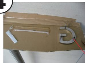
4.付属のスペーサーをボルトに通してからボルト周りに速乾ボンド
